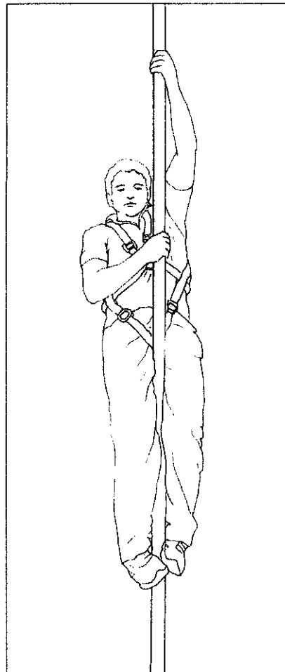
figura 3: Discesa della pertica con imbragatura di sicurezza NON collegata al dispositivo anticaduta
